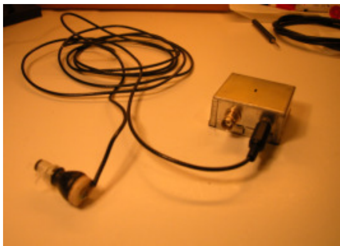
Figur 16 – Komplet opstilling med modificeret mundstykke og mikrofontilslutningsboks.
